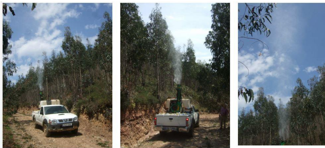
Figura 17. Tratamiento químico con cañón nebulizador. Fuente: Elaboración SPMF (Fuente: PLI Cantabria)
