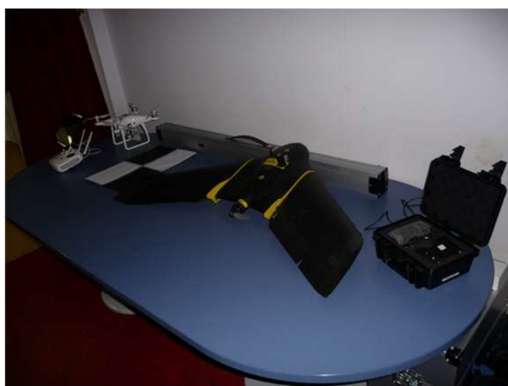
Drones empleados: multirrotor Phantom4Pro con cámara RGB y ala fija eBee+ con cámara RGB y multispectral
