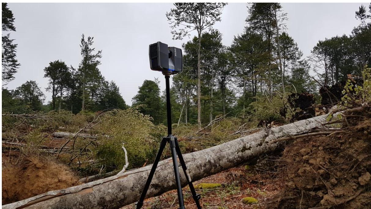
Escaneo con un láser 3D de una parte del hayedo afectado. Esta operación permite medir los fustes afectados por el derribo y, en el futuro, comprobar el crecimiento de las hayas resistentes.
